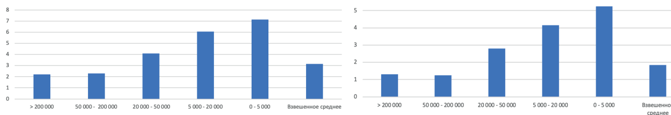
Рис. 3. Средняя длина уличной водопроводной и канализационной сети на одного обслуживаемого жителя в населенных пунктах Молдовы с разной численностью населения (в погонных метрах)
